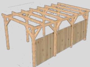
Konstruktion Grundgerüst + Seitenverkleidungen
